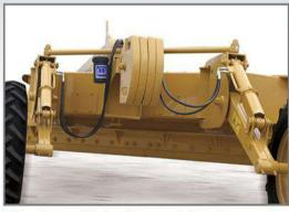
»Trocha variable dentro del ancho de corte de la vertedera mediante sistema de paralelogramo.
