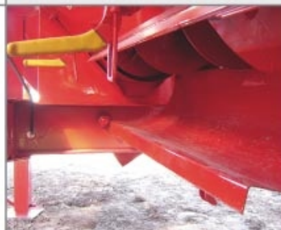
Como opcional se provee a la base del sinfin horizontal con sistema de desenganche rápido (sistema patentado OMBU), lo que evita el estancamiento de agua y desechos, facilitando la limpieza de la tolva para casos de acarreos de distintas variedades de granos. Imprescindibles en recolección para semilleros.
