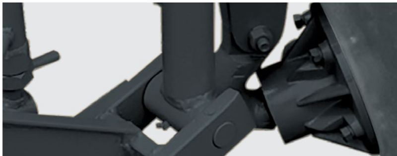
Cubo dos discos de rolamentos cônicos à graxa com lubrificação permanente. Greased conical disc hub (lubrication free). Maza de los discos con rodamientos cónicos con grasa.
