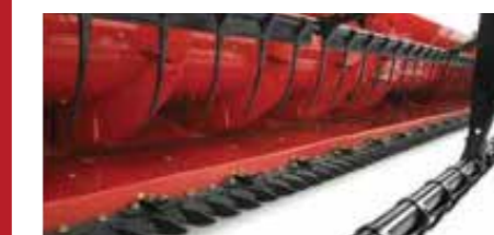
Cabezal de grano: sin fin de mayor diámetro, con Dedos retráctiles en toda la longitud
