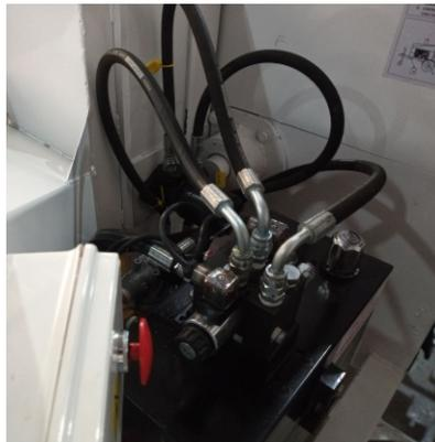
Las funciones del sistema de control de estrés, NO STRESSES, se basa en el monitoreo de RPM disco, parando los rodillos de alimentación hidráulica para su rápida recuperación, y evitar así el patinamiento de correas y sobre exigencias de motor
