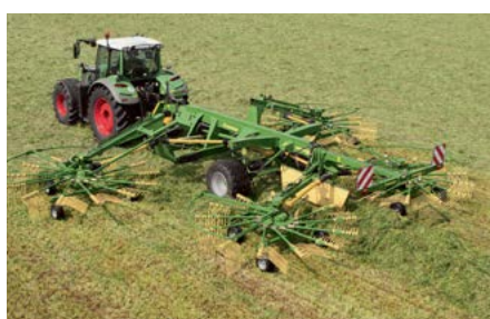
Modelos de descarga central con cuatro rotores Swadro 1400 y 1400 Plus Anchos de trabajo variables de 11,00 m a 13,50 m
