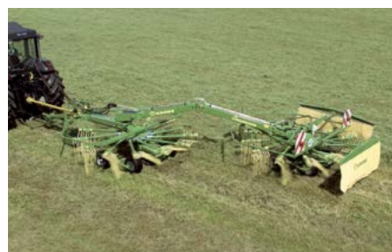
Modelos de descarga lateral con dos rotores Swadro 710/26T Anchos de trabajo 6,20 m o 2 x 3,40 m
