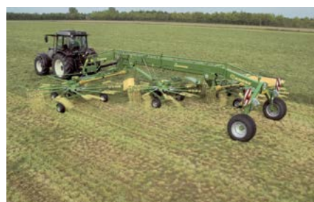
Modelo de descarga lateral con dos rotores Swadro 1010 Ancho de trabajo 9,70 m
