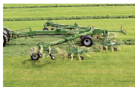
Modelo de descarga central con seis rotores Swadro 2000 Anchos de trabajo variables de 11,00 m a 19,00 m
