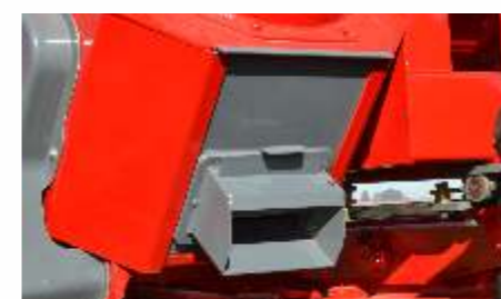
Puerta de descarga rápida delantera con boquilla para llenado de bolsas.
