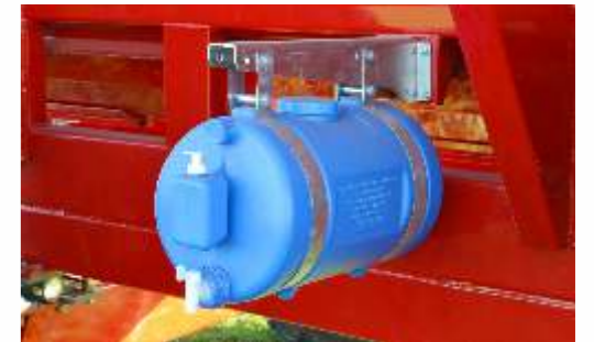
Tanque de agua limpia para manos. 10 l de capacidad con dispenser de jabón incorporado.
