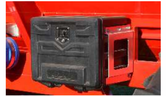
Cajón de herramientas con llave. Material plástico rotomoldeado.
