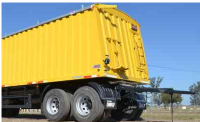
Sección delantera: Porta auxilio, baulera, escalera.
