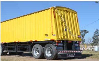
Sección trasera: Escalera, paragolpes reglamentario, luces leds y accionamiento de cobertura de lona.
