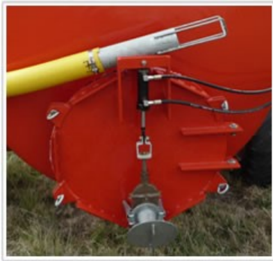
Tapa pasa hombre para limpieza e inspección. Acoples expuestos con tratamiento
