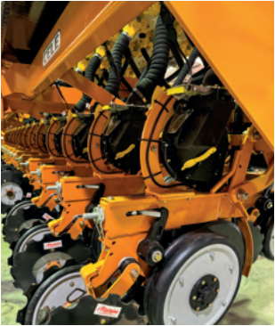
* Neumático: La sembradora Activa III de G.F Neumática está equipada con un sistema auxiliar hidráulico. El cuerpo de siembra se adapta a cualquier dosificador del mercado.
