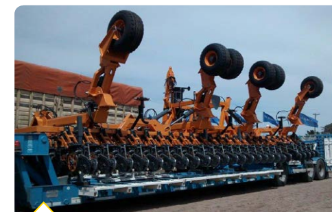
Novedoso y práctico sistema de carga sobre camión (patente en trámite). Original and practical truck loading system (patent pending).
