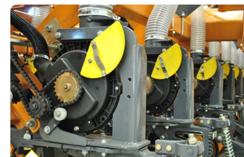
Dosificador Neumático (opcional) para la siembra de granos gruesos. Pneumatic dispenser (optional) for coarse grain planting.
