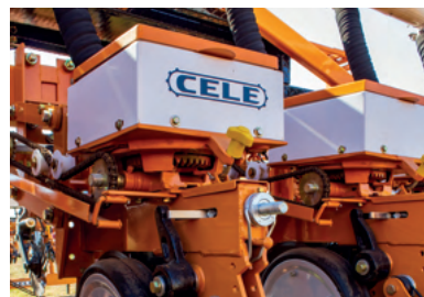
* Mecánico: Dosificador libre de mantenimiento.
