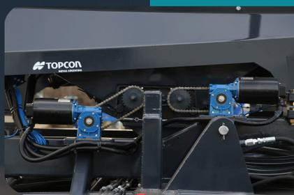
Sistema electrónico Topcon. ARTEMIS es un control automático VRC accionados por motores eléctricos. El software se puede configurar para controlar hasta 4 productos/ motores. En combinación con el XD/XD+, los 4 canales puede funcionar de acuerdo con un mapa de prescripción variable. Asimismo el control de encendido/apagado de la cabecera detendría/arrancaría los motores en función del mapa de cobertura.
