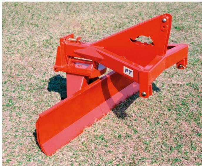
El fácil manejo de la cuchilla trasera permite su uso en las más diversas condiciones y tipos de suelo. Los raspadores son reversibles y tratados térmicamente, con alta resistencia al desgaste. La estructura resistente asegura mayor durabilidad.
