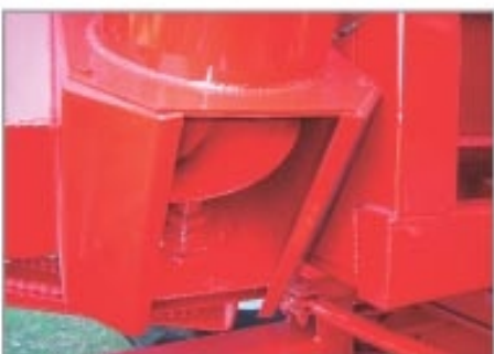
• RIENDAS INTERIORES DE SUSTENTACION Enganches internos para elevación y guillotina de regulación.
