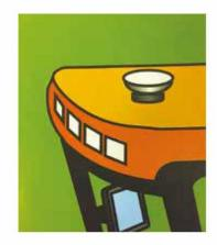
El monitor montado en la cabina registra la información sobre rendimiento y humedad captada por los sensores.
