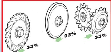
Una buena siembra directa se logra haciendo que la semilla quede a la profundidad deseada, constante y con un contacto íntimo suelo-semilla. El tren de siembra BERTINI logra hacer una cama de siembra con una cuchilla ondulada (dura fluted, wavy, rippled o turbo) que corta y clava en los residuos de rastroios.
