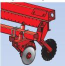
CUCHILLAS FLOTANTES AL CHASIS, **FLOTANTES A LA BARRA Y DOBLE DISCO APLICADOR DE FERTILIZANTE** AL COSTADO DE LA LINEA Nuestras sembradoras tienen la posibilidad de colocar en la barra portaherramientas un abresurco de doble disco y una tolva de abono para realizar la fertilización lateral. Es la configuración anterior con los discos de
