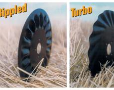
Actualmente se consiguen los siguientes modelos de cuchillas. El peso necesario para penetrar depende de las condiciones del suelo y del ancho de cada cuchilla. La elección depende de la zona donde la máquina vaya a trabajar.
