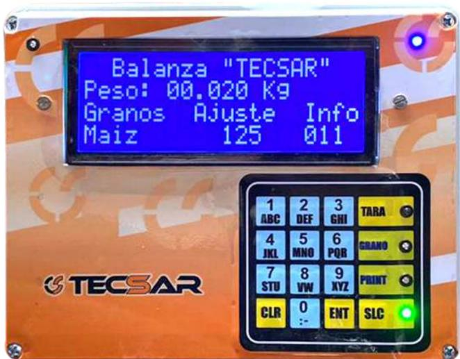
Se selecciona el tipo de cereal y la balanza pesa todo lo que pasa que pasa por encima de la boquilla de descarga, mostrando continuamente el peso real descargado en el camión.
