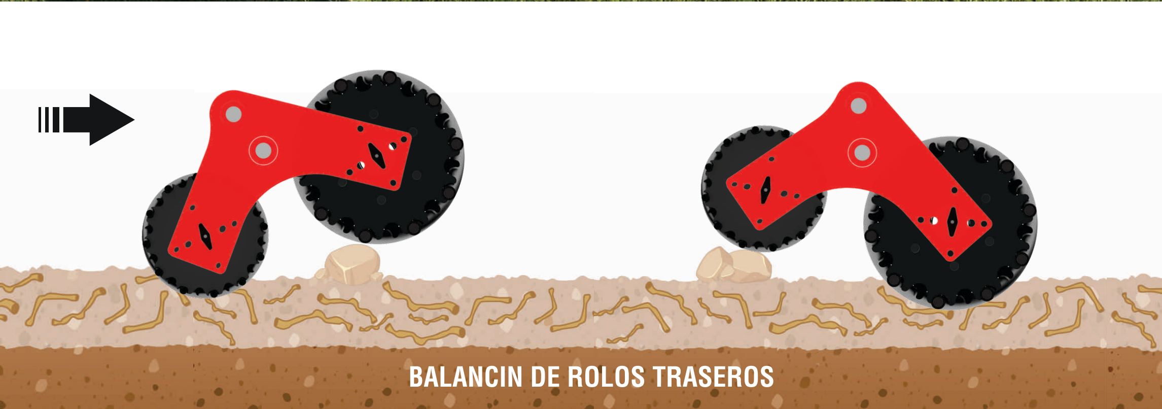
ROLO PICADOR INDEPENDIENTE PICA RASTROJOS, CORTA PAREJO
