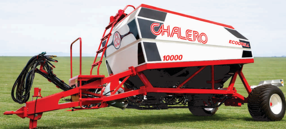
ECODRILL TOLVA 10000 LT. INCORPORA FERTILIZANTE Y SIEMBRA
